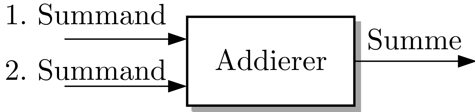
Abb. A.16. Blockschaltbild des Addierers
